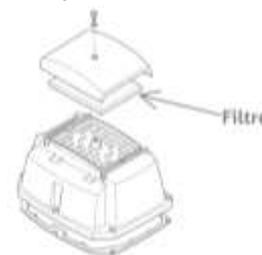
Les **pompes** utilisées pour les Tricel Novo avec pompe intégrée sont adaptées aux applications en eaux usées. Les pompes doivent être vérifiées et nettoyées chaque année afin d'augmenter leur durée de vie attendue d'au moins 8 ans. Pour nettoyer la pompe, il suffit d'ouvrir le raccord à déclenchement rapide connecté sur la prise d'évacuation, puis de retirer la pompe en la levant de son support par la poignée (tige filetée hors d'eau) prévue à cet effet.
