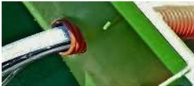
Tirer dans ce fourreau le tuyau d'alimentation en air (19 mm pour les FR6 à FR11 – 2 x 19 mm pour la FR14 – 25 mm pour les FR17 et FR20) et le tuyau noir de recirculation des boues, ainsi que, dans le cas de la version avec pompe intégrée, le câble d'alimentation de la pompe et le câble de flotteur d'alarme.
